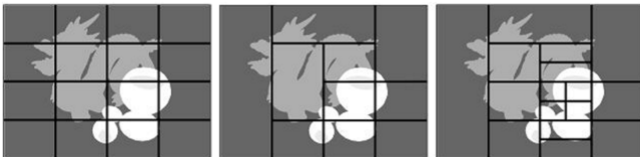
Figura 5. Mapas de importancia. Izquierda: Particionamiento a ciegas (Primer Nivel). Centro: Zonas de unión con complejidad similar (Segundo Nivel). Derecha: Equilibrio ratio complejidad/tamaño (Tercer Nivel).
